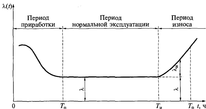
Рис. 1.3. Функция интенсивности \lambda(t) отказов экспоненциального распределения
